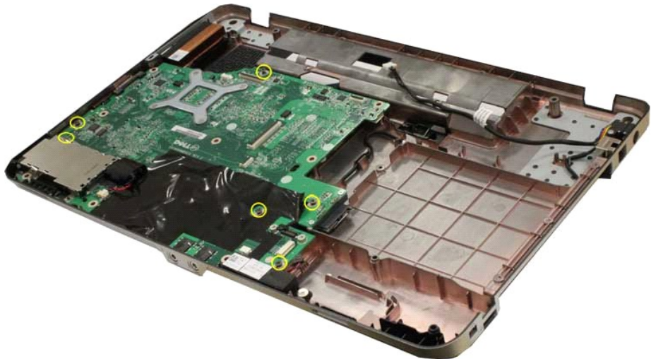
91. ارفع لوحة النظام لأعلى وبعيداً عن هيكل الكمبيوتر.
