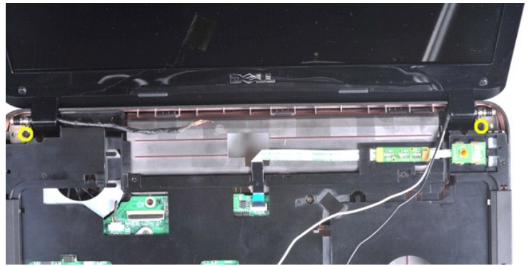
41. ارفع مجموعة الشاشة عن الكمبيوتر. تأكد من إزالة كافة الكبلات بحذوية من الكمبيوتر.
